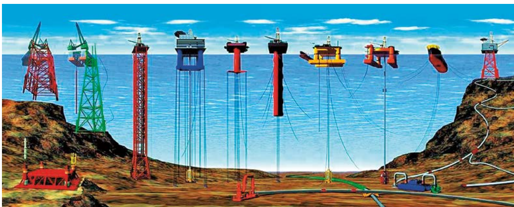
Eksempler på forskjellige typer utbyggingsløsninger med ulike bruksområder og investeringskostnader, for eksempel undervannsutbygginger, flytende eller bunnfaste innretninger.
